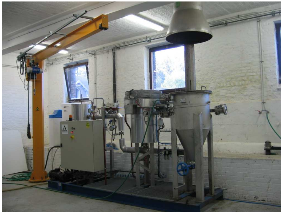
Figure 6 DESSUS Schéma général d'une installation d'explosion à la vapeur comprenant un générateur de vapeur, un réacteur et un éclateur telle qu'elle a été développée à Gembloux Agro-Bio Tech. 1. Pompe haute pression. 2. Colliers chauffants. 3. Mesures de pression et de température du générateur. 4. Mesures de pression et de température du réacteur. 5. Vanne d'isolement. 6. Vanne de mise en charge. 7. Soupape de sécurité du générateur. 8. Soupape de sécurité du réacteur. 9. Vanne d'éclatement. 10. Vanne de purge lente; 11. Vannes de récupération des produits. 12. Manomètre éclateur. 12 DESSOUS Photographie de l'équipement d'explosion à la vapeur à Gembloux Agro-Bio Tech (Reproduced by courtesy of Nicolas JACQUET, GxABT)
